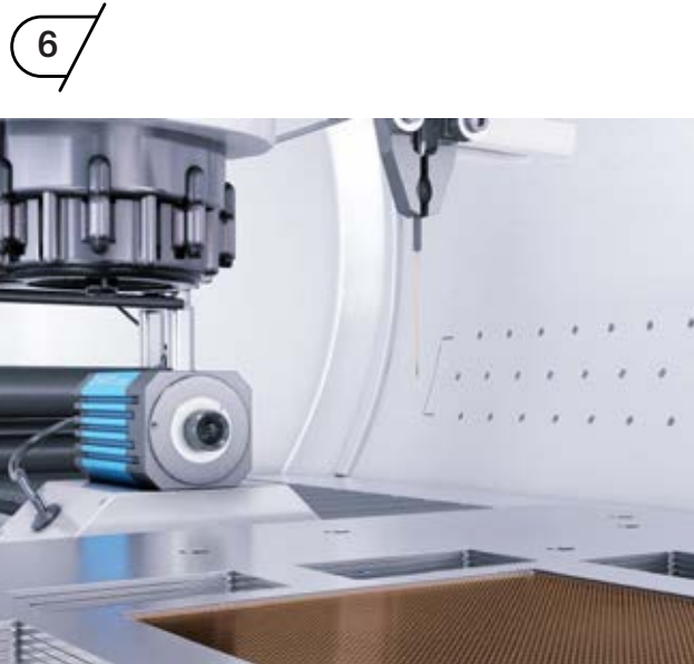
圖 5、6. 透過嚴格篩選機制挑選出尺寸一致之探針，以 AI 機器手臂植入至探針卡且確保測試的穩定度。
