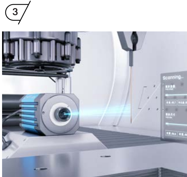
圖 3、4. 以 AOI 光學檢驗確認探針外觀、尺寸、針型等高品質探針。
